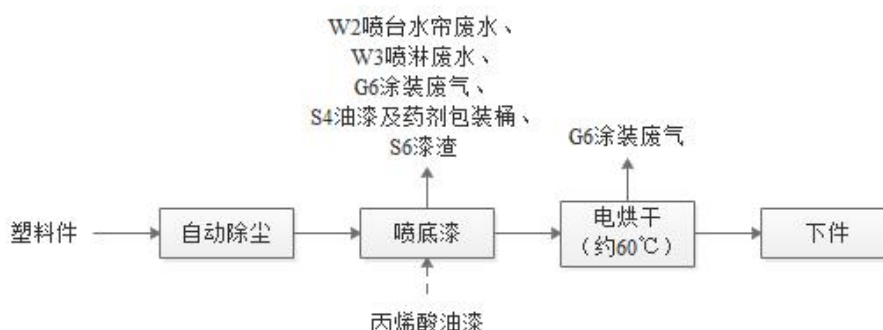
图 3-4 底漆线生产工艺流程及产污流程图
